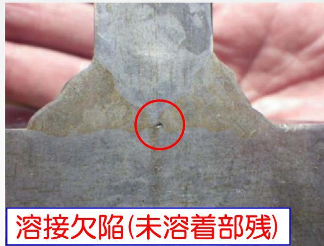
溶接欠陥(未溶着部残)
