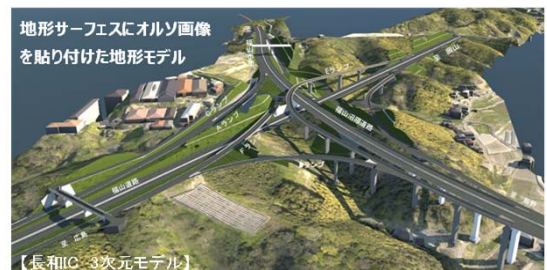
図 複雑なJCT構造を3次元モデルで説明
