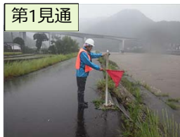
橋より浮子を投下して第一見通と第二見通の区間距離50mのところまで時間を計測することで流速を求める
