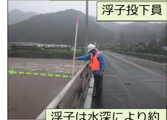
浮子は水深により約0.1m~4.0mを使用
