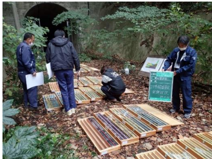
掘削分類(岩盤)
